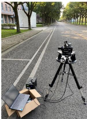
图1 架空输电线路弧垂智能测量与控制样机外观图
